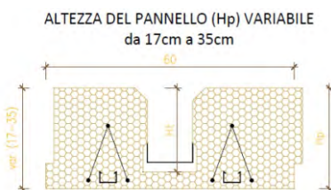
Particolare sezione Termosolaio
